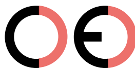
Faux marquage CE (trop éloigné)
